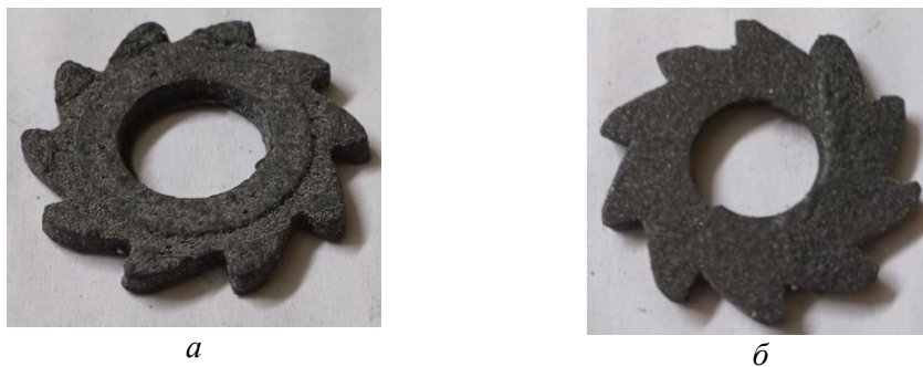
Рис. 11. Спечена у кораксі в середовищі аргону фреза, що була надрукована з філаменту, наповненого сумішшю ВК8 50 % ВК8 + 50 % Зв. (50 % Парафін+50% ТРП): а – верх заготовки, б – низ заготовки
