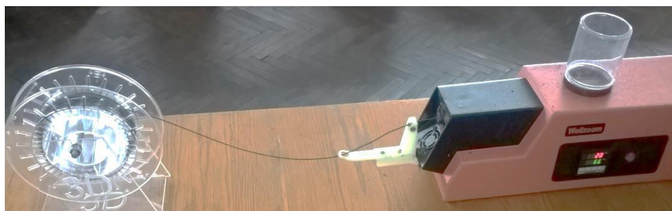
Рис. 3. Процес екструзії та намотування філаменту
