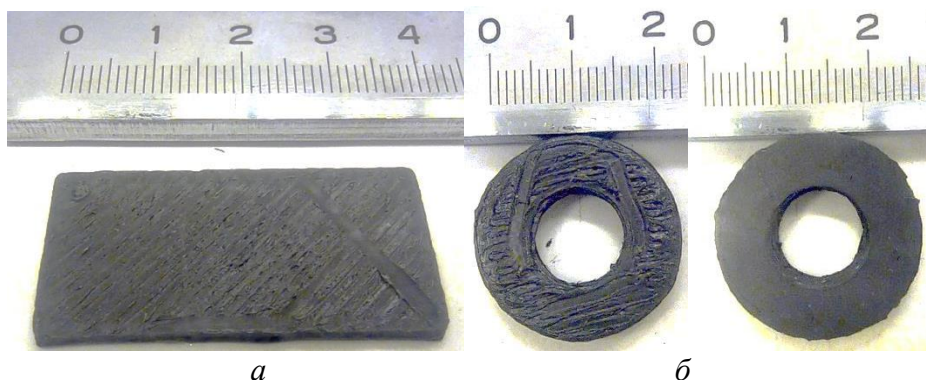
Рис. 10. Надруковані пластина та кільце з філаменту, наповненого сумішшю ВК8 50 % ВК8 + 50 % Зв. (50 % Парафін+50% ТРП): а – пластина, б – кільце (верх та низ)
