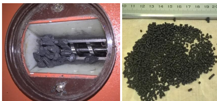
Рис. 2. Завантажені в екструдер подрібнені кусочки високонаповненої термопластичної маси (а) та гранули для екструзії філаменту (б)
