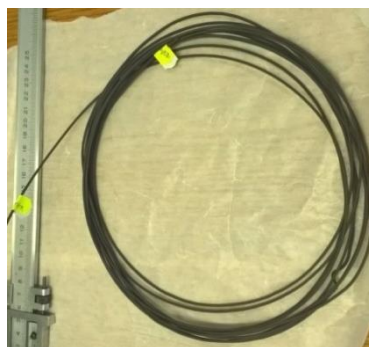
Рис. 4. Екструдований філамент на основі парафіну, ТР полімеру та твердосплавної суміші ВК8 або ВК20, діаметр філаменту 1,6–1,75 мм
