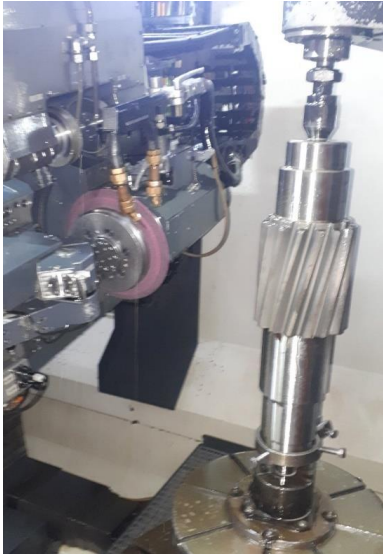
Рис. 2. Зона обробки на шліфувальному верстаті кругом з рубін-корунду
