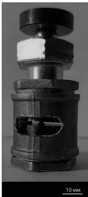
Рис. 2. Вигляд маніпулятора, розробленого для експериментів з визначення статичної міцності зразків монокристалів синтетичного алмазу
