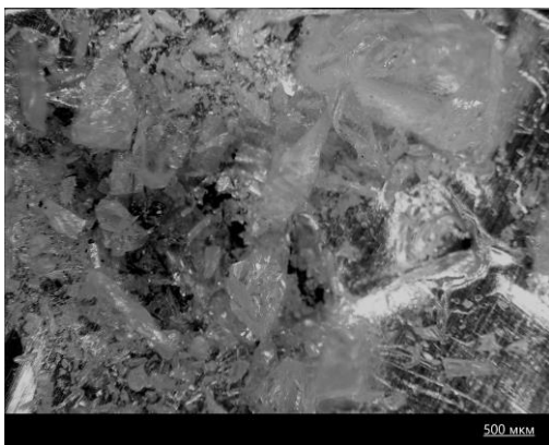
Рис. 4. Загальний вигляд уламків після руйнування в процесі визначення граничної міцності кристала №9, табл. 1, значення зусилля навантаження F_{кр} = 3,75 кН
