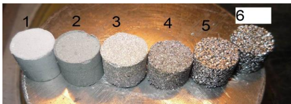
Рис. 1. Спресовані зразки порошоків вольфраму різної зернистості з додаванням 10 % (по масі) оксиду WO_3 : 1 – 3–5 мкм, 2 – 5–100 мкм, 3 – 40–100 мкм, 4 – 100–300 мкм, 5 – 300–500 мкм, 6 – 500–1000 мкм
