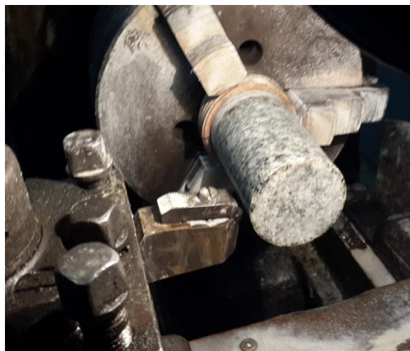
Рис. 1. Зовнішній вигляд стенду для дослідження зносостійкості зразків полікристалів алмазу та композиту «алмаз – карбід вольфраму»
