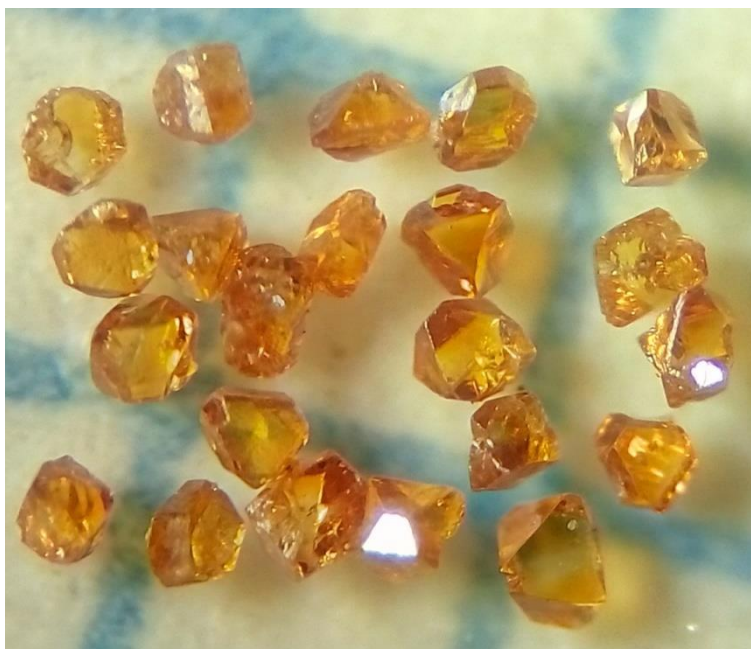
Рис. 5. Монокристали c\text{BN} торгової марки Кібор розміром до 300 мкм, синтезовані методом спонтанної масової кристалізації в ростовій системі \text{BN-Li}_3\text{N} з добавками азот-, бор- і водень-вмісних сполук (Шульженко А. А., Соколов А. Н., 1980 [27])
