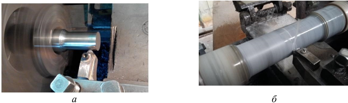
Рис. 6. Фотоснимки процесса точения заготовки ВК15 (а) и керна гранита (б)
