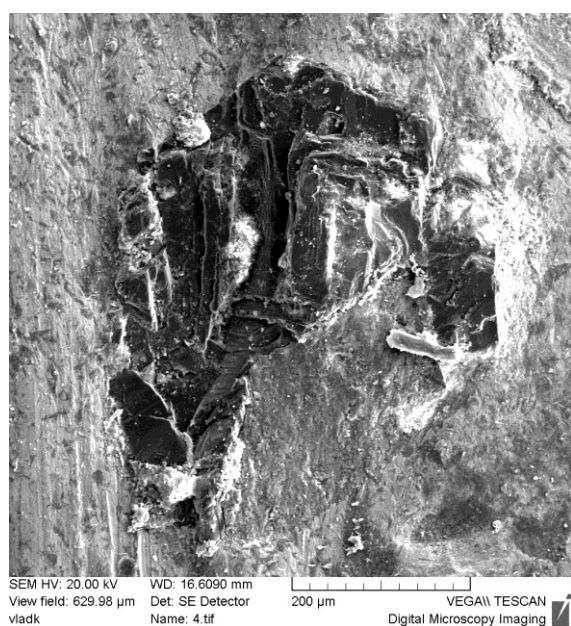
Рис. 2. Морфология поверхностей износа алмазосодержащих композиционных материалов при обработке стали: а – морфология поверхности сегмента с монокристаллами алмаза; б – морфология поверхности сегмента с гранулами поликристаллического алмаза; в – морфология поверхности монокристалла алмаза; г – морфология поверхности матрицы композиционного материала
