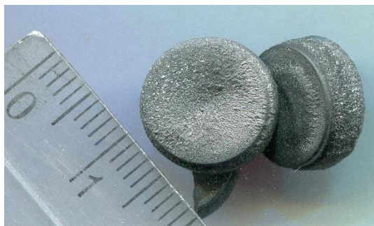
Рис. 1. Зразки композиту, отриманого в системі алмаз- \text{TiNi}_3 після термобарического спікання
