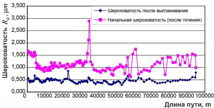
Рис. 5. Зависимость шероховатости обрабатываемой заготовки из стали 40X от длины пути, пройденного наконечником, армированным композитом АКТМ+
