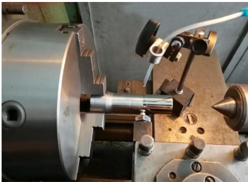
Рис. 4. Заготовка из стали 40X, закрепленная на универсальном токарном станке С11
