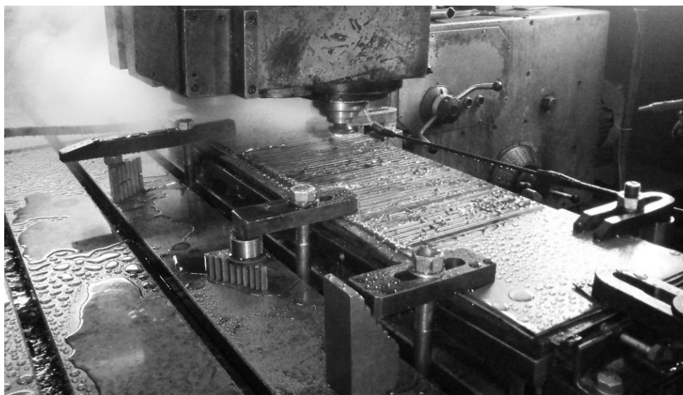
Рис. 6. Процес нанесення 3 мм шару нікелю на мідну плиту МБЛЗ методом СТП
