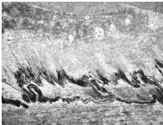
Рис. 5. Мікроструктура з'єднання нікель - мідь, отриманого СТП, подовжній перетин травлення ( \times 25 )
