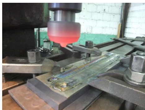
Рис. 1. Установка (а) і схема процесу СТП (б): 1 – виріб; 2 – запічники; 3 – пін інструменту спеціального профілю; V_{св} – швидкість зварювання; V_{об} – швидкість обертання
