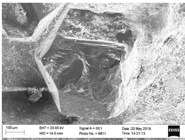
Рис. 3. Вигляд фрагмента робочої поверхні бурової коронки, оснащеної алмазами відібраної партії
