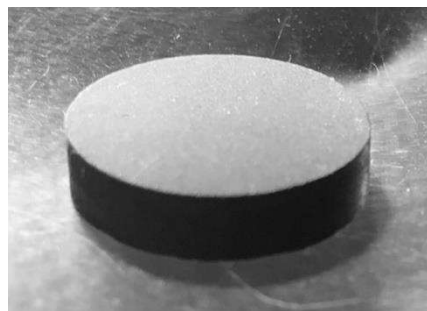
Рис. 5. Алмазні полікристалічні елементи після механічної обробки
