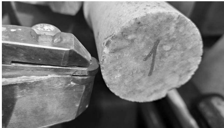
Рис. 2. Процес дослідження зносостійкості зразків алмазних полікристалічних елементів діаметром 15 мм та висотою 3 мм
