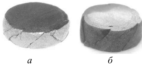
Рис. 4. Зразки WC(Co) (28,4 % Co по масі) після випробування на стиск: а – p_{np}=50 МПа; б – p_{np}=100 МПа
