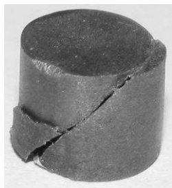
Рис. 3. Руйнування просоченого міддю зразка WC(Co) (3,2 % Co по масі)
