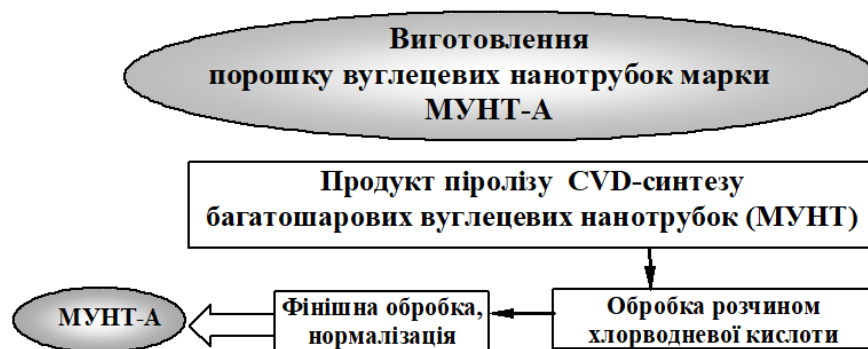
Рис. 1. Принципова схема виготовлення порошку вуглецевих нанотрубок марки МУНТ-А
