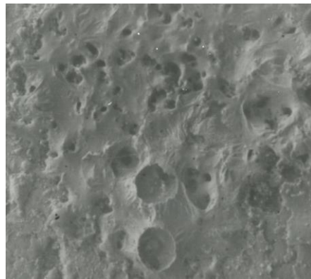
Рис. 4. Наявність лунок електроерозійних розрядів на робочій поверхні круга при електроерозійному шліфуванні
