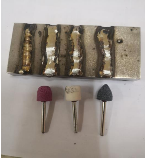
Рис. 3. Вид дослідного зразка після оброблення різними абразивними головками
