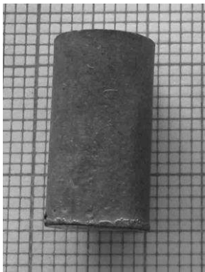
Рис. 2. Зовнішній вигляд зразка твердого сплаву ВН8, спеченого в вакуумі з прикладанням та без прикладання одноосьового стиску
