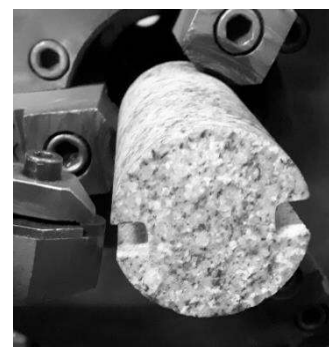
Рис. 4. Вигляд керну граніту з пазами, встановленого в патрон токарного верстата, та різця із механічно закріпленою пластиною з композиту алмаз–Fe 3 C
