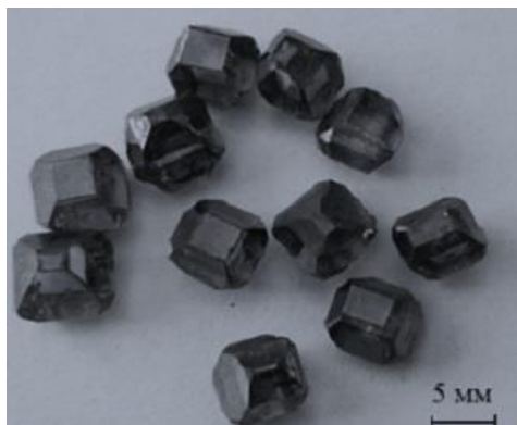
Рис. 2. Монокристали алмаза типу Ib, отримані в циклах вирощування тривалістю вирощування t=118-120 год, маса кристалів 3,5 – 4,2 каратів
