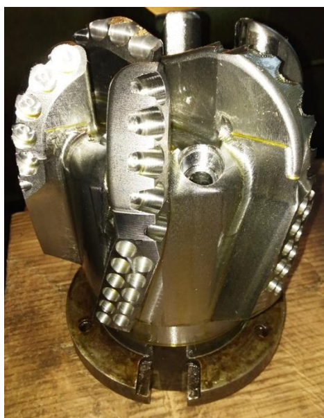
Рис. 5. Корпус долота після операції фрезерування, встановлений на спеціальній оправці-супутнику
