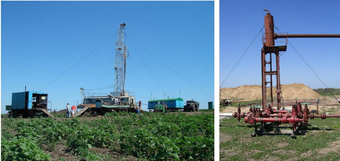
Рис. 1. Приклади облаштування бурових майданчиків та їх плануванні за умов використання земель активного сільгоспкористування (розвідувальні та експлуатаційні свердловини)
