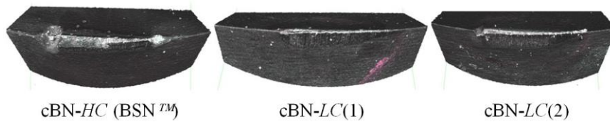
Рис. 7. 3-D мікроскопія типової морфології зносу інструменту з композиту BN групи ( cBN-НС ) в порівнянні з композитами BL групи cBN-LC(1) і cBN-LC(2) при точінні суперсплаву Інконель 718
