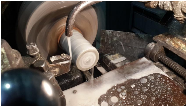
Рис. 1. Стенд для випробування спечених зразків на зносостійкість
