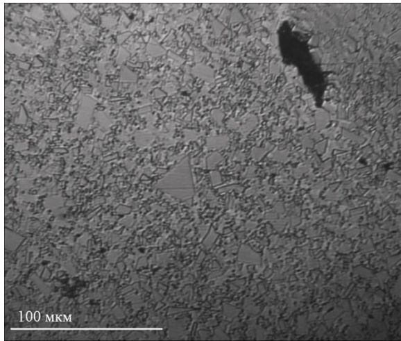
Рис. 4. Мікроструктура сплаву WC – 10 мас. % Co, спеченого при температурі 1800 °C з витримкою 10 хв; травлення 4 хв реактивом Муракамі; \times 500
