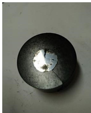
Рис. 3. Залежність значень модуля Юнга для зразків на основі cBN з різним вмістом мікрОВОЛОКОН карбїду кремнію від температури спікання (а); зовнішній вигляд зруйнованого зразка (складу 50% cBN, 45% TaN, 5% Al) (б)
