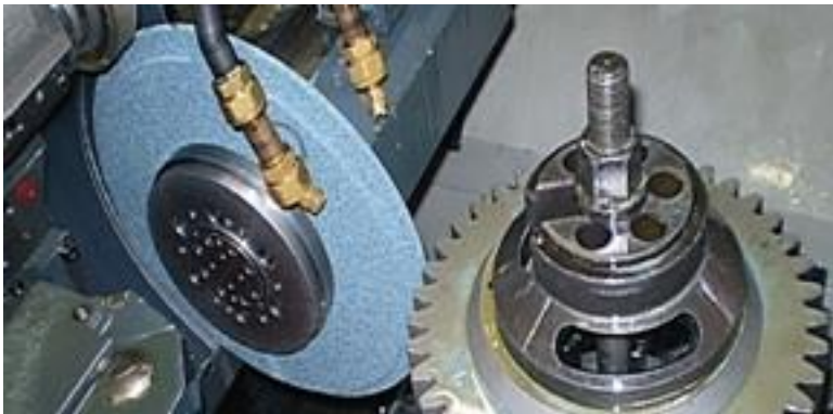
Рис. 1. Зона обробки зубчастого колеса на шліфувальному верстаті
