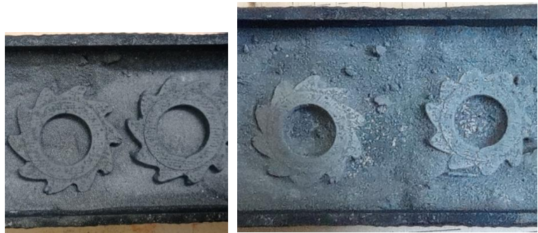
Рис. 9. Вироби після відгонки зв'язуючого (П/В) (а) та спечені вироби (б) з композиції 55 % ВК8+(50 % П+50 % В)
