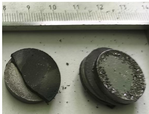
Рис. 5. Спечені сплави WC–30%Co–TiC–WC–30%Co у формі таблеток з п'ятьма шарами.
