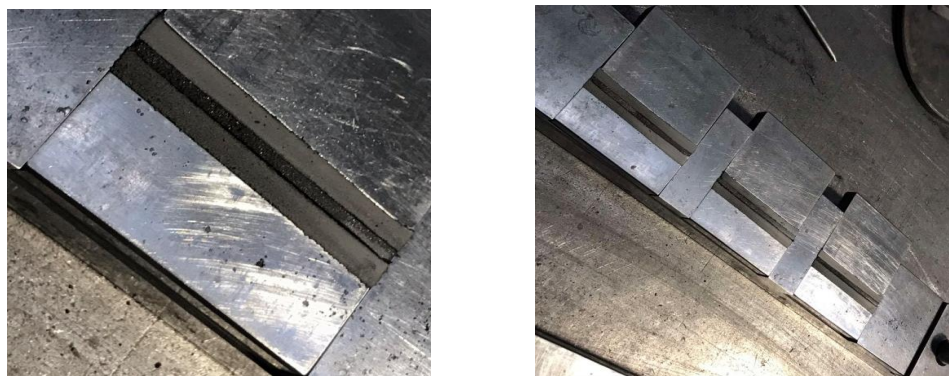
Рис. 1. Розміщення шарів тришарового композиту WC–30%Co–TiC–WC–30%Co в прес-формі
