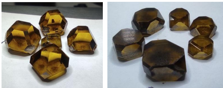
Рис. 2. Загальний вигляд зразків монокристалів алмазу, вирощених на затравках в системі Fe–Ni–C: а – кубооктаедричний габітус, тривалість циклу вирощування 210 год, маса 9,87, 8,05, 7,53, 7,64 та 3,89 карат; б – кубічний габітус, тривалість циклу вирощування 238 год, маса 8,11, 7,36, 7,45, 5,07, 5,39 та 5,21 карат
