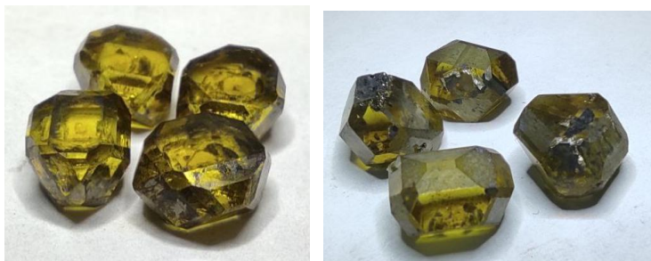
Рис. 3. Загальний вигляд зразків монокристалів алмазу кубооктаедричного габітуса, вирощених на затравках в системі Fe–Co–C: а – тривалість циклу вирощування 126 год, маса 4,28, 3,42, 3,13 та 3,92 карат; б – тривалість циклу вирощування 131 год: маса 5,43, 3,19, 3,44 та 5,27 карат
