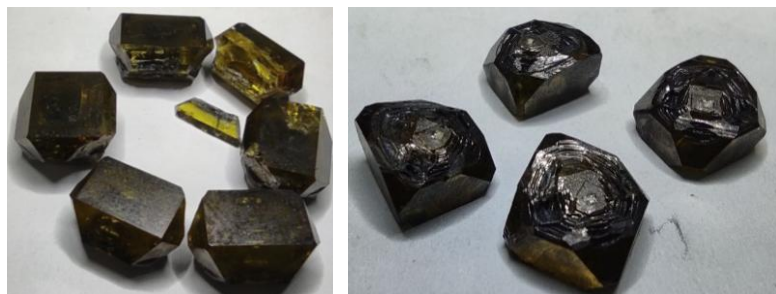
Рис. 4. Загальний вигляд зразків монокристалів алмазу кубооктаедричного габітуса, вирощених на затравках в системі розчинник Fe–Co–Mg–C: а – тривалість циклу вирощування 178 год, один кристал зруйнувався в процесі витравлювання з розчинника; маса зразків 8,13, 8,71, 8,67, 7,98; 7,25 (зруйнований) та 6,66 карат; б – тривалість циклу вирощування 155 год; маса 7,12, 6,82, 6,88 та 6,97 карат
