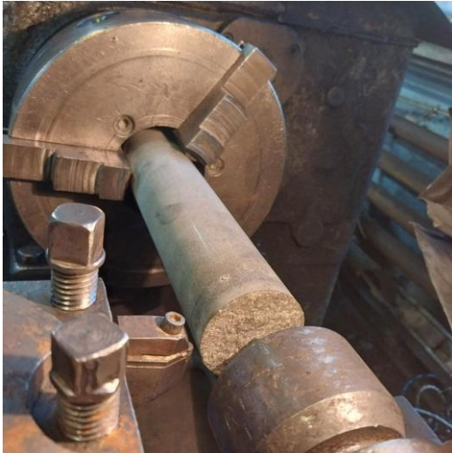
Рис. 1. Визначення зносостійкості на верстаті 1К62
