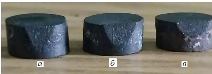
Рис. 3. Зображення зразків № 1 (а), № 2 (б) та № 3 (в) після проходження випробувань зносостійкості
