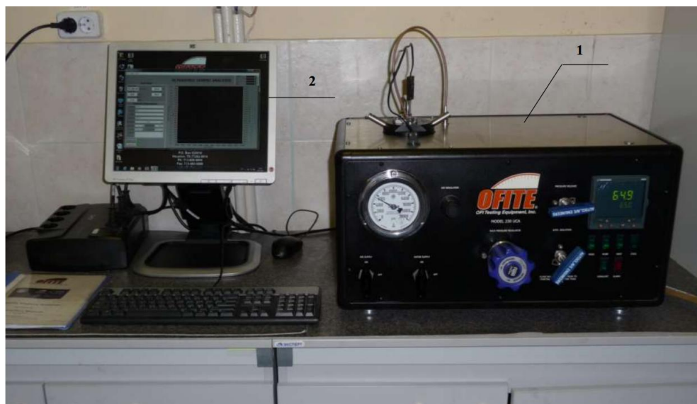
Рис. 1. Ультразвуковий аналізатор цементу USA OFI Testing Equipment: 1 – прилад-моноблок, 2 - комп'ютер зі спеціалізованим програмним забезпеченням «OFITE USA»
