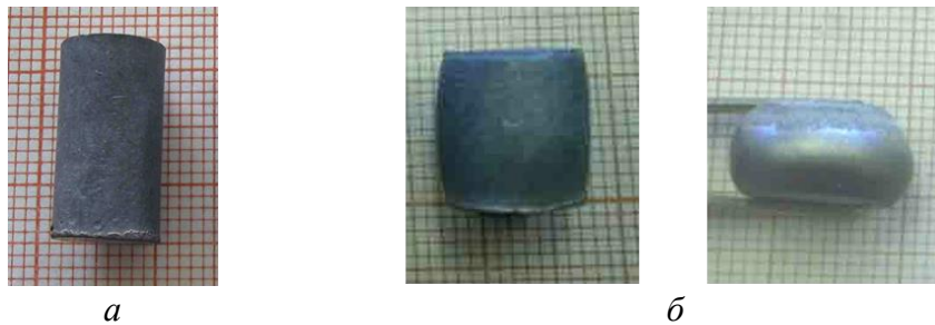
Рис. 1. Типовий зовнішній вигляд твердосплавного зразка, спеченого в вакуумі після попереднього спікання у МВС (а), а також зразка, кінцевоспеченого (з утворенням форми «бочка») у вакуумі під впливом одноосьового тиску з різним ступенем усадки (б)
