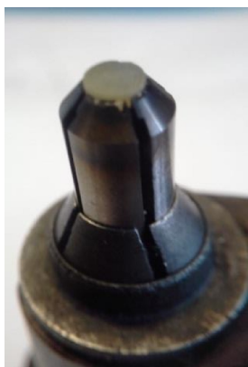
Рис. 7. Монокристалл природного алмаза, подготовленный к эксперименту
